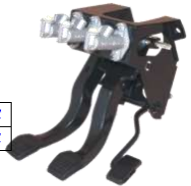
Pédalier suspendu inversé 2 pédales en alu 2 maîtres cylindres de frein 0.750 et 1 d'embrayage 0.625
